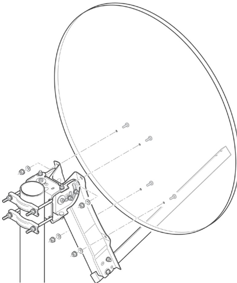
3. Установите фиксатор конвертера iLNB на подвес.
