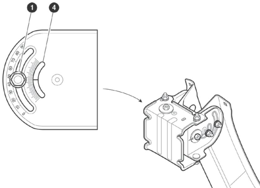
Примечание. Эта гайка должна быть затянута с максимальным усилием, поскольку положение наклона не должно изменяться при дальнейшей установке антенны.
