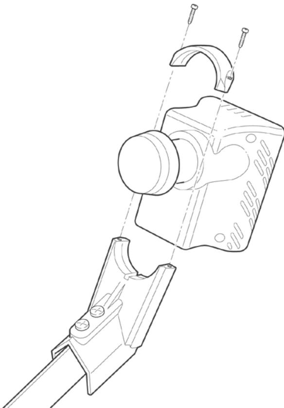
Установка антенны завершена. Перейдите к выполнению следующего шага — регулировке поляризации конвертора iLNB.
