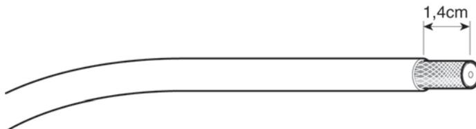
2. Отогните защитную оболочку провода на изоляционный слой кабеля.
