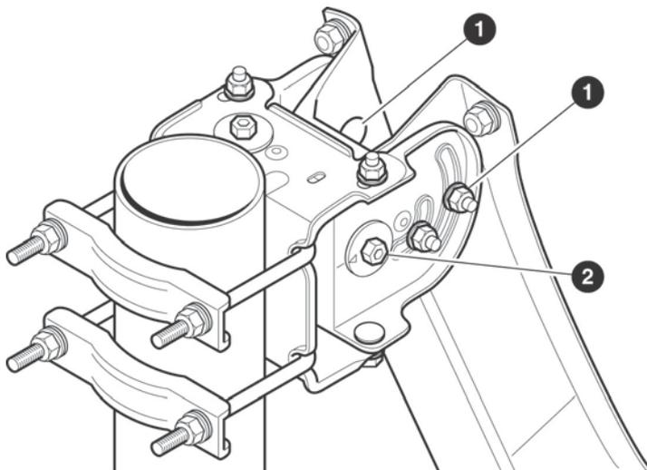
2. Отрегулируйте угол наклона, поворачивая болт точной регулировки угла наклона (2) с помощью ключа на 10 мм, пока устройство Point&Play не выдаст самый высокий непрерывный звуковой сигнал.
