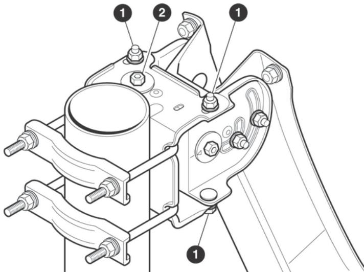
2. Отрегулируйте угол азимута, поворачивая болт точной регулировки угла азимута (2) с помощью ключа на 10 мм, пока устройство Point&Play не выдаст самый высокий непрерывный звуковой сигнал.
