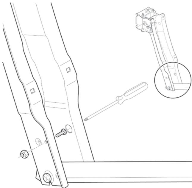
Это действие завершает процесс установки комплекта заземления на мачтовое основание. Оставшиеся предметы из комплекта заземления будут использованы позднее при заземлении конвертора iLNB. Теперь можно перейти к выполнению следующего шага — установке угла наклона.
